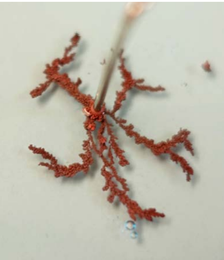
KUPFERBÄUMCHEN Bei der Elektrolyse einer Kupfer(II)-sulfat-Lösung scheidet sich an der Kathode elementares Kupfer als »Bäumchen« ab.
