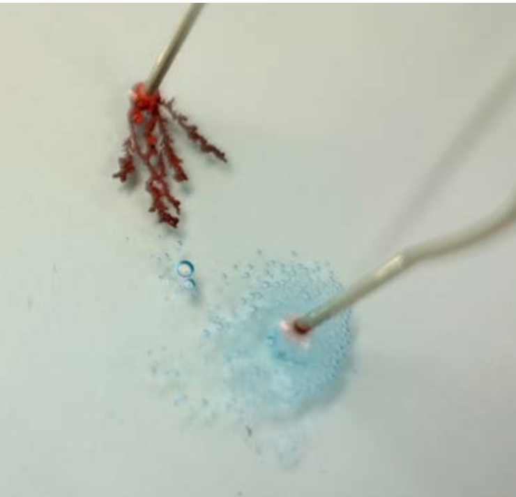
KUPFERBÄUMCHEN Bei der Elektrolyse einer Kupfer(II)-sulfat-Lösung scheidet sich an der Kathode elementares Kupfer als »Bäumchen« ab.
