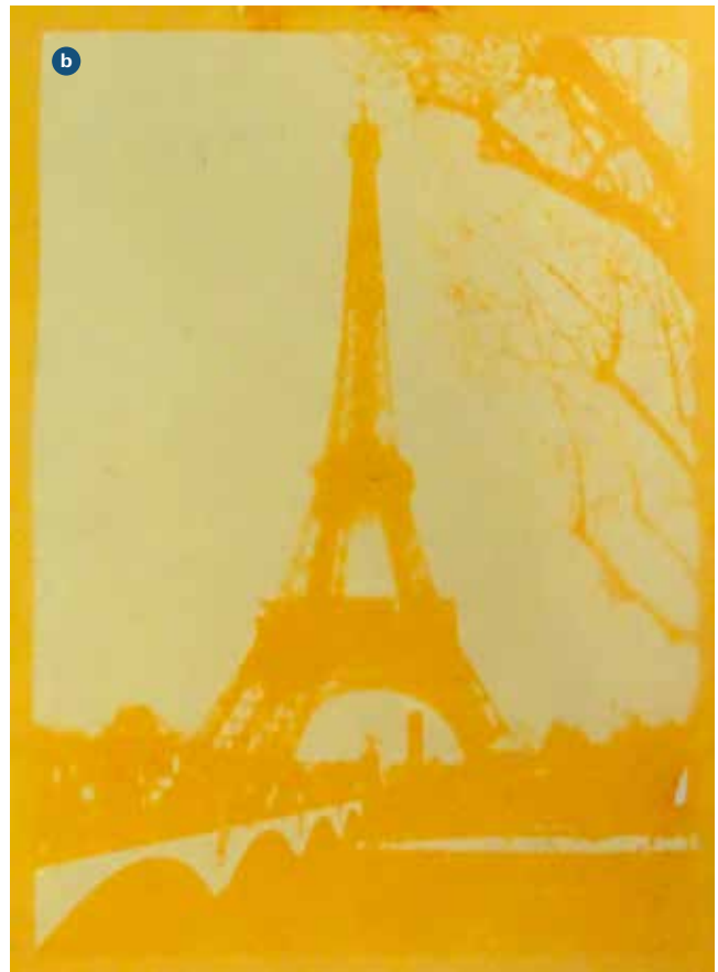
LA TOUR EIFFEL Verwendete Schwarz-Farblos-Folie a und das davon durch Diazotypie erhaltene Bild in gelbem Azofarbstoff bei Tageslicht b sowie unter UV-Licht c . Das Bild zeigt den Eiffelturm in Paris. Im Hintergrund ist in der Bildmitte der Tour Montparnasse ebenfalls erkennbar.
