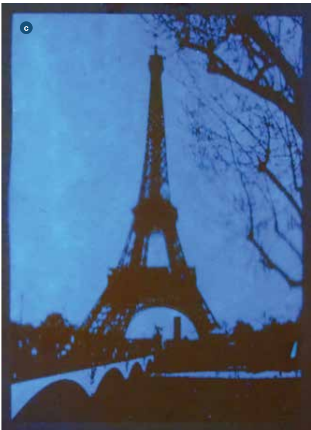
LA TOUR EIFFEL Verwendete Schwarz-Farblos-Folie a und das davon durch Diazotypie erhaltene Bild in gelbem Azofarbstoff bei Tageslicht b sowie unter UV-Licht c . Das Bild zeigt den Eiffelturm in Paris. Im Hintergrund ist in der Bildmitte der Tour Montparnasse ebenfalls erkennbar.
