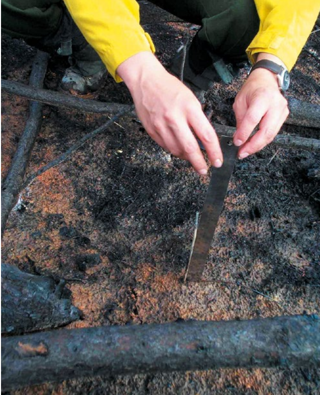
DIE TORFSCHICHT im hohen Norden kann bis zu 50 Zentimeter dick werden (Lineal, oben). Wie viel davon nach einem Brand verschwunden ist, überprüfen Fachleute mit Hilfe von Metallstäben, die vorher in den Torf eingebracht wurden (links).
