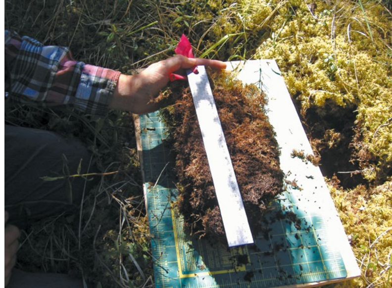
DIE TORFSCHICHT im hohen Norden kann bis zu 50 Zentimeter dick werden (Lineal, oben). Wie viel davon nach einem Brand verschwunden ist, überprüfen Fachleute mit Hilfe von Metallstäben, die vorher in den Torf eingebracht wurden (links).
