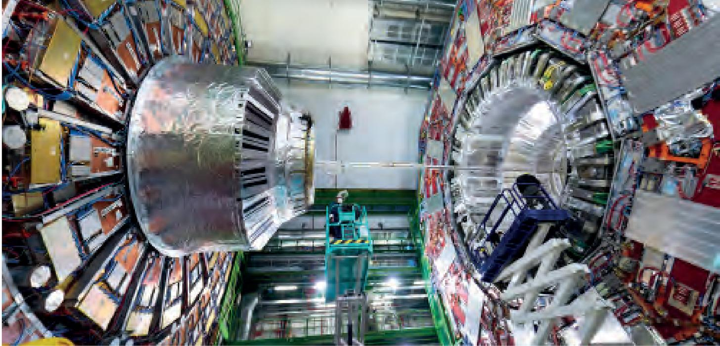
**CMS-UPGRADES** Während der Umbauarbeiten wurden am CMS-Detektor Technologiedemonstratoren installiert. Das soll Erfahrungswerte für den zukünftigen High-Luminosity LHC liefern.
