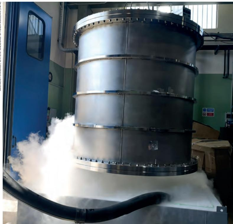
**KRYOSTAT** Die Experimentatoren haben getestet, wie man einen so großen Aufbau mit flüssigem Stickstoff kühlen kann. Dafür haben sie eine große Styroporwanne mit dem Kühlmittel gefüllt und die Vakuumkammer langsam hinabgelassen.
