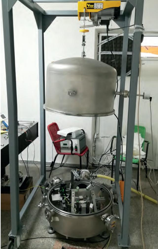
**PROTOTYP** Um zu testen, ob sich eine so empfindliche Balkenwaage überhaupt realisieren lässt, haben die Forscherinnen und Forscher zunächst einen Prototyp entworfen, der etwas kleiner und einfacher gehalten ist als der endgültige Aufbau.
