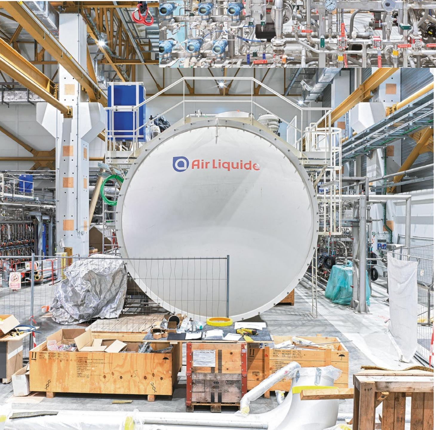
**MAGNETKÄFIG** Diverse Spulen halten das Plasma gefangen und in Form. Dazu gehören so genannte poloidale Magnete, die den Torus an sechs Stellen horizontal umringen. Eine solche Spule ist hier abgebildet. Hinzu kommen 18 toroidale Magnete in vertikaler Richtung, ein zentraler »Solenoid« in der Mitte sowie zahlreiche kleinere Korrekturspulen.
