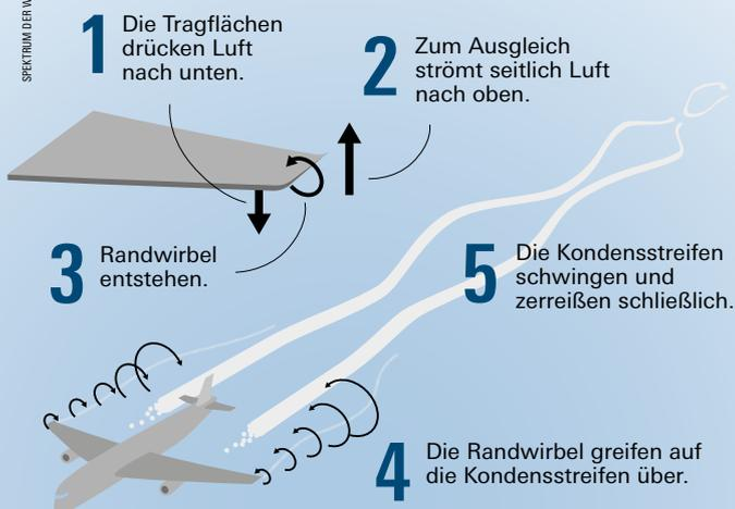
**Oft treten die beiden gegensinnig rotierenden Kondensstreifen miteinander in Wechselwirkung und zerfallen allmählich.**
