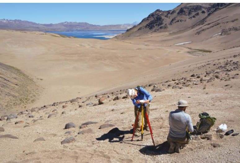
Geologen installieren in der Umgebung des Sees Messgeräte, um zu ermitteln, wie stark sich der Boden hebt.
