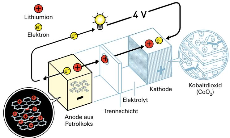
Physikalisch betrachtet ist Lithium ideal für eine Batterie, denn es hat unter allen Elementen die stärkste Neigung, sein äußerstes Elektron abzugeben, so dass potenziell hohe Spannungen möglich sind. Gleichzeitig ist es das leichteste Metall und gibt gemessen an seinem Gewicht viel Energie ab.
