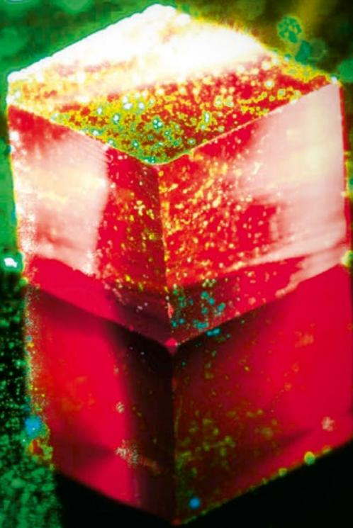
»Stickstofffehlstellen« im wenige Millimeter kleinen Diamanten lassen den Kristall unter grünem Laserlicht rot fluoreszieren.
