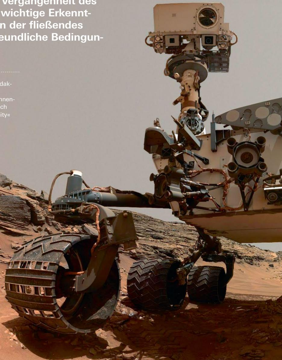
Gelegentlich schießt der Rover Selbstporträts mit seiner an einem langen Arm angebrachten, hochauflösenden Kamera. Nach dem Zusammenfügen der zahlreichen Einzelbilder erscheint der Arm selbst wie abgeschnitten. Dieses Foto entstand am 1065. Marstag des Rovers (5. August 2015) am Fuß des Kraterbergs.
