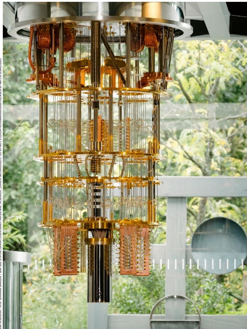
**Das Herzstück eines Quantencomputers (hier ein Exemplar von IBM außerhalb seines Behälters) enthält zahlreiche Leitungen und Elektronik, um die Qubits im untersten, am stärksten gekühlten Bereich anzusteuern und auszulesen.**
