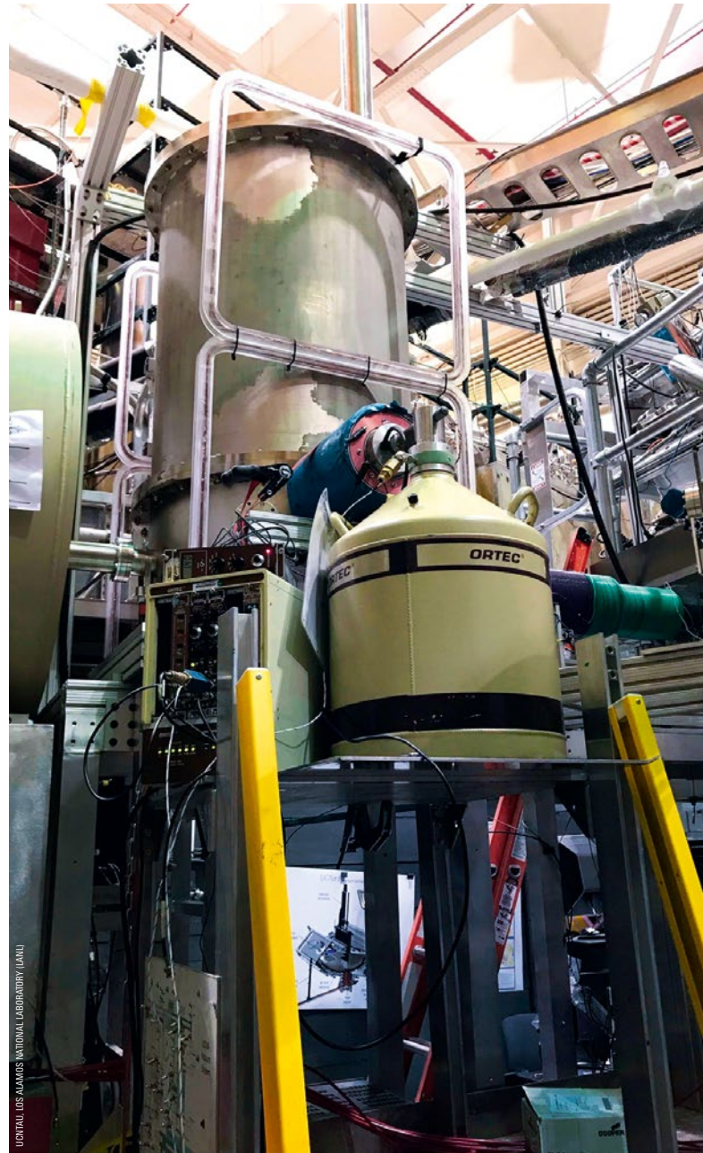
Beim Experiment UCNTau am Los Alamos National Laboratory speichern Physiker freie Neutronen in einer Flasche und messen, wie lange es dauert, bis die Teilchen zerfallen.
