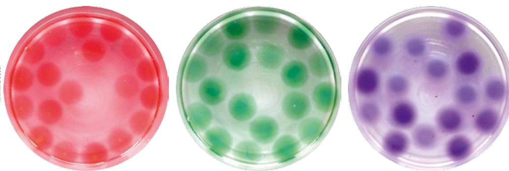
Alginatebällchen mit eingeschlossenem pH-Indikator aus einem Testset der Firma JBL sind unterschiedlich gefärbt, je nachdem, ob sie sich in einem sauren, neutralen oder alkalischen Medium befinden (von links nach rechts).
