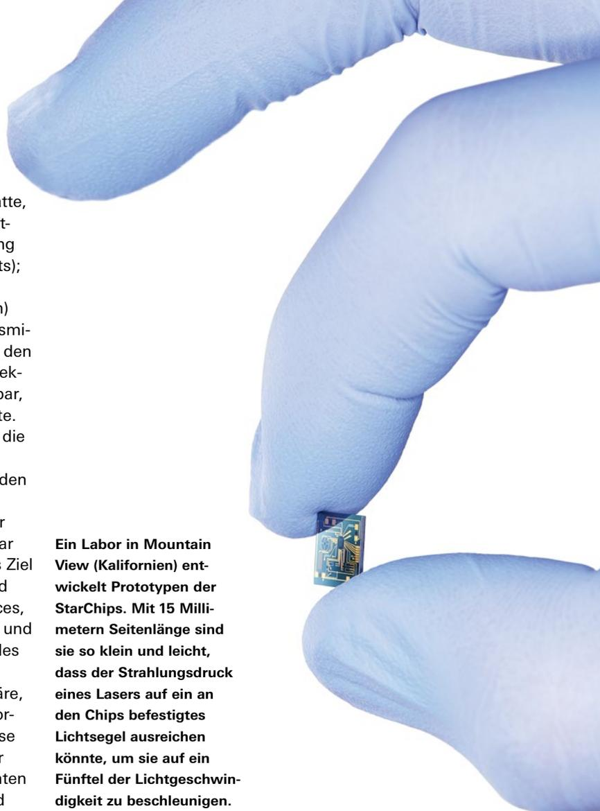
**Ein Labor in Mountain View (Kalifornien) entwickelt Prototypen der StarChips. Mit 15 Millimetern Seitenlänge sind sie so klein und leicht, dass der Strahlungsdruck eines Lasers auf ein an den Chips befestigtes Lichtsegel ausreichen könnte, um sie auf ein Fünftel der Lichtgeschwindigkeit zu beschleunigen.**
