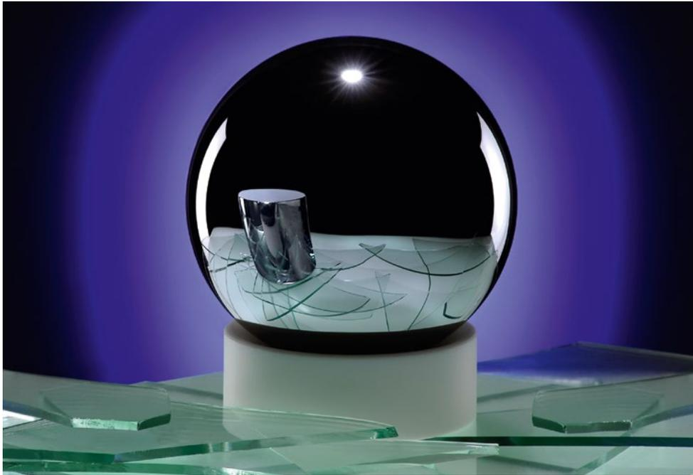
Mit einer solchen Kristallkugel aus hoch angereichertem Silizium-28 haben Metrologen aus Deutschland, Italien und Japan die so genannte Avogadro-Konstante so genau wie nie zuvor ermittelt. Da sie exakt ein Kilogramm wiegt, soll die Kugel künftig auch für die Kalibrierung von Waagen genutzt werden.
