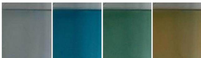
Mit diesem Versuchsaufbau ist es möglich, durch Anlegen unterschiedlicher Spannungen die vier Oxidationsstufen und Farbzustände des Berliner-Blau-Systems zu durchlaufen.
