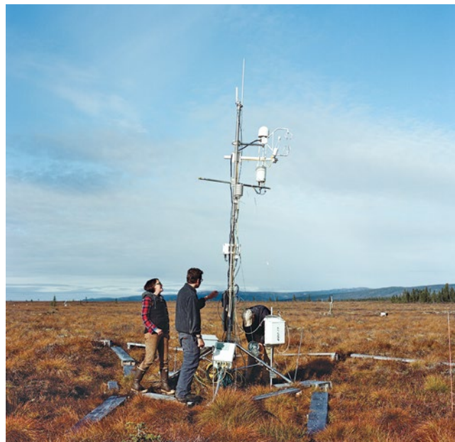
Das ganze Jahr über misst ein Instrumententurm, wie viel Kohlendioxid und Methan der Boden der Tundra freisetzt. So ermitteln die Forscher, ob das Ökosystem unter dem Strich Treibhausgase aufnimmt oder abgibt.
