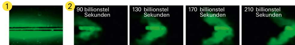
Ein Laserpuls durchläuft einen Kanal mit niedrigem Brechungsindex, sein Licht tritt zum Teil ins umgebende Material ein (1, lang
