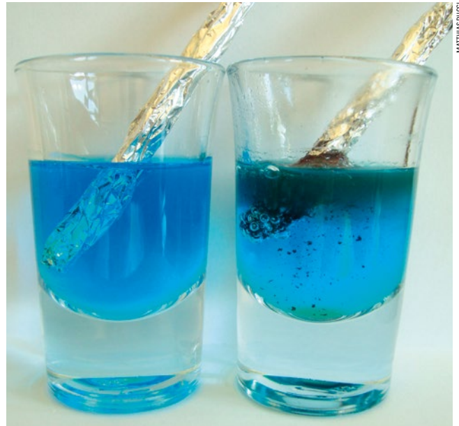
Taucht man einen Eisennagel in Kupfersulfat-Lösung, überzieht er sich mit einer Kupferschicht (links). Bei Aluminiumfolie geschieht das nicht. Erst nach Zusatz von Kochsalz kommt es zu einer heftigen Reaktion. Dabei scheidet sich Kupfer auf dem Aluminium ab, während zugleich ein Gas entweicht (rechts).
