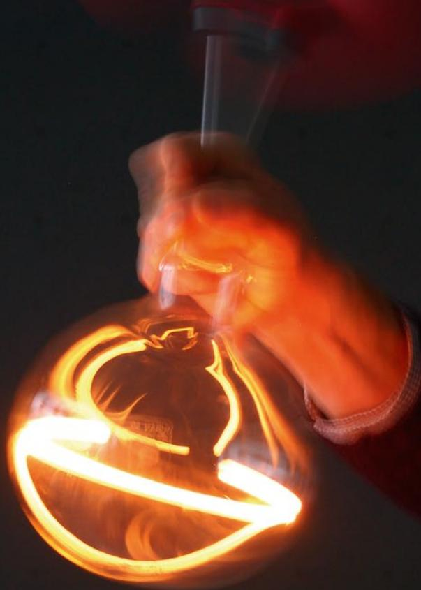
Wird Aktivkohle in einem Glaskolben mit Sauerstoff erhitzt, verbrennt sie unter intensivem Leuchten.
