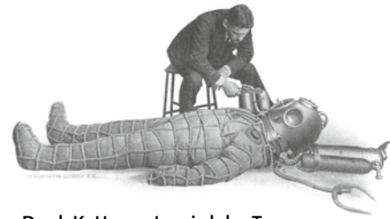
Dank Kettennetz wird der Taucheranzug zur Druckkammer.
