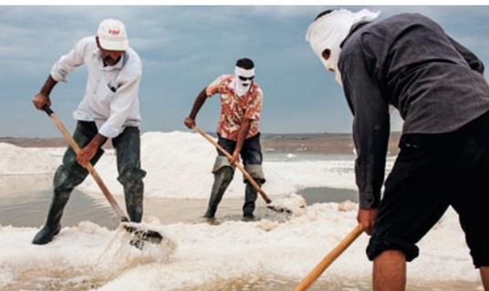
Am Mirzaladi-See in Aserbaidschan schaufeln Arbeiter gelockerte Salzkruste zu großen Haufen (oben). Dort trocknet das Salz, bevor es mit Lastwagen zur Fabrik gefahren wird.
