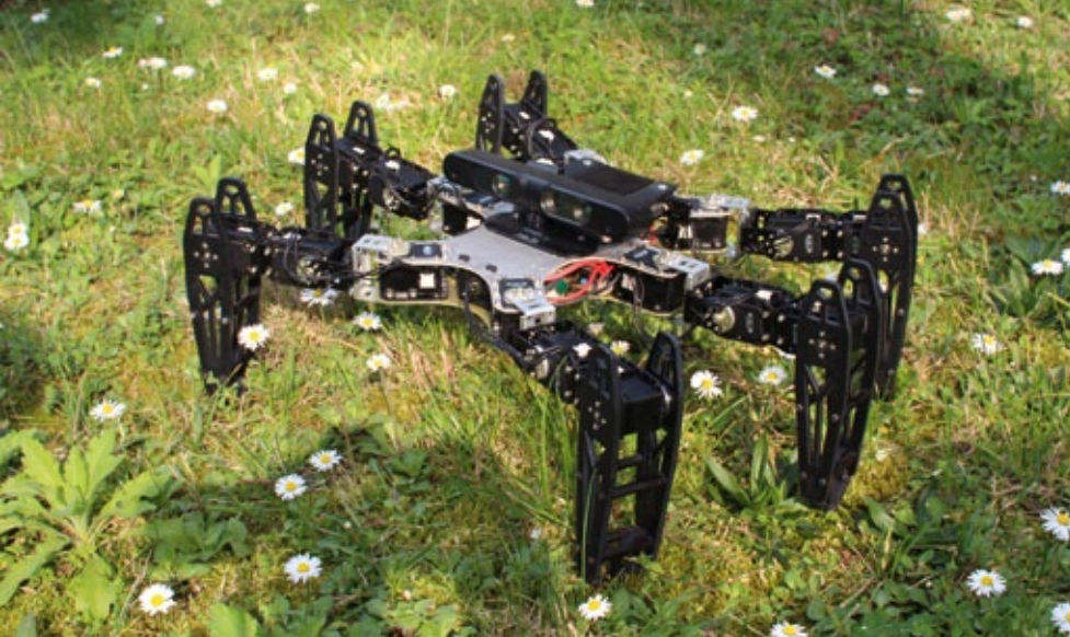
Ein intakter sechsbeiniger Roboter läuft dank seiner Stereokamera und dem eingebauten Computer mühelos auch über unebenes Gelände.
