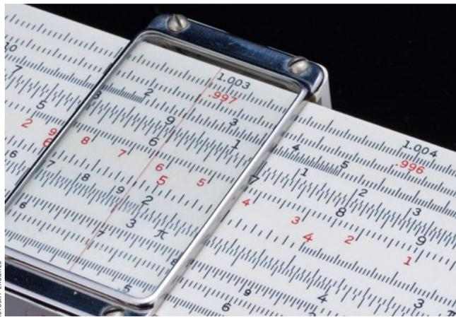
Bevor bezahlbare Taschenrechner verfügbar wurden, löste man aufwändigere Berechnungen mit Hilfe der logarithmisch geteilten Skalen von Rechenschiebern.
