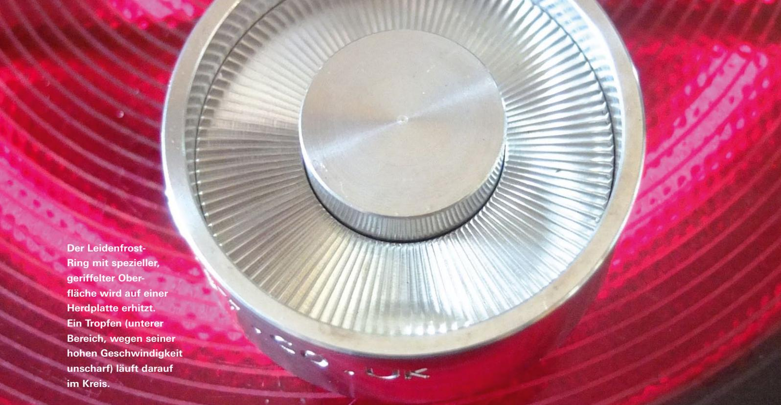
Der Leidenfrost-Ring mit spezieller, geriffelter Oberfläche wird auf einer Herdplatte erhitzt. Ein Tropfen (unterer Bereich, wegen seiner hohen Geschwindigkeit unscharf) läuft darauf im Kreis.
