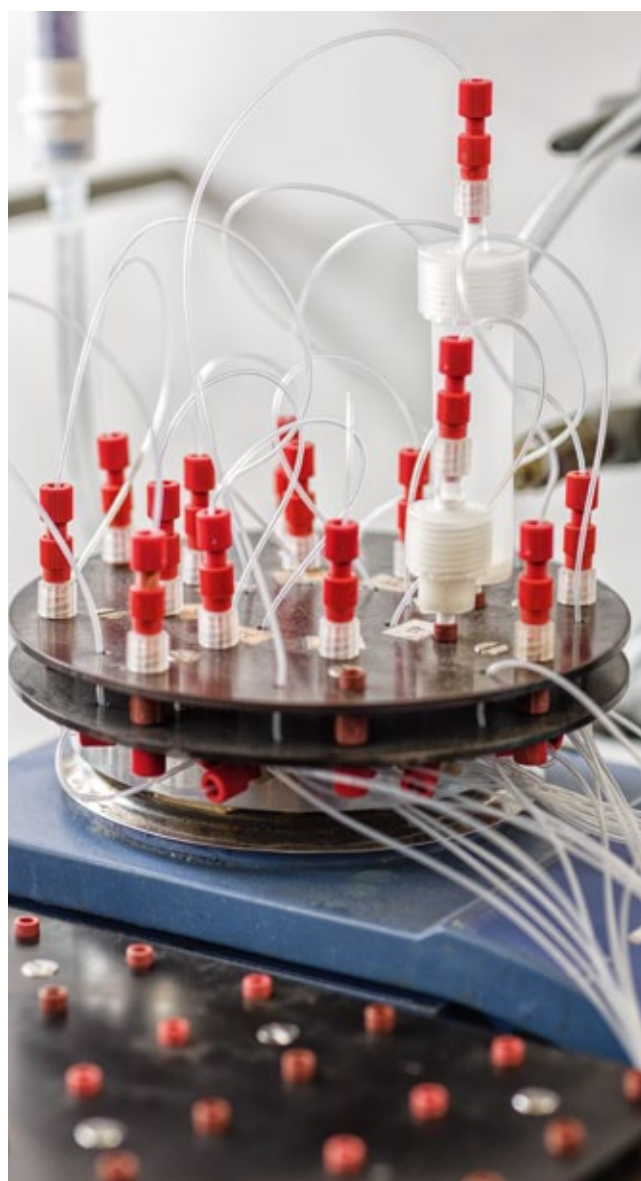
Schläuche leiten die Ausgangsverbindungen aus Fläschchen ins Innere des Automaten. Dort werden sie schrittweise zu den gewünschten Molekülen verknüpft.
