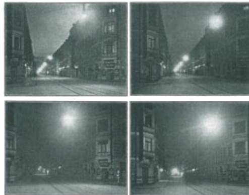
Mitternächtlicher Lampentest in Dresden: Effektbogenlampe (links); hochkerzige Glühlampe (rechts).
