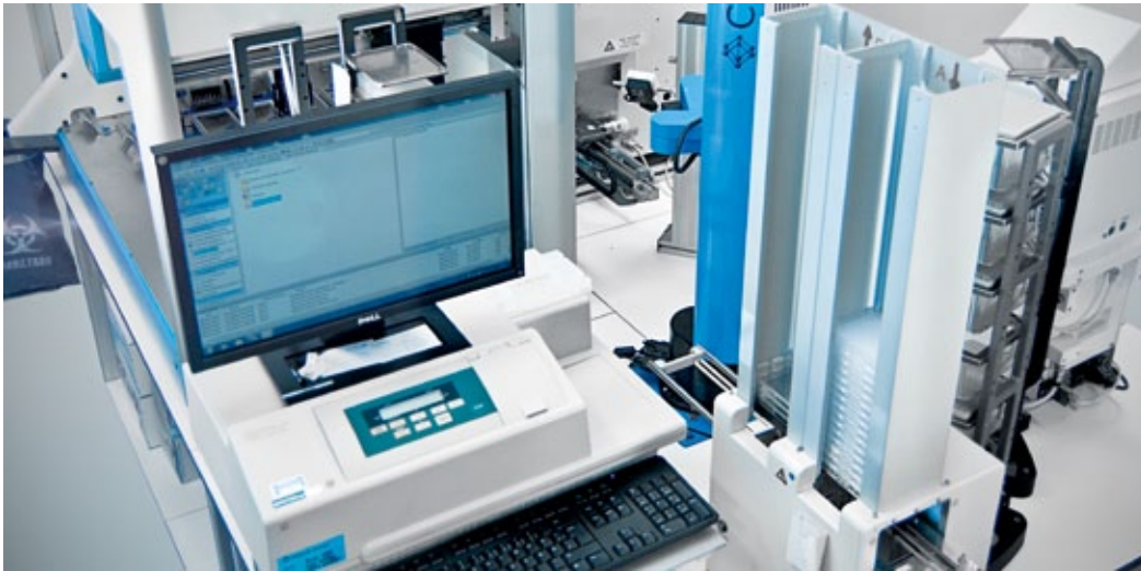
Roboter zur automatisierten Proteomfraktionierung. Rechts im Bild sieht man eine Vorrichtung, die jeweils 96 Proben gleichzeitig pipettieren kann. Der Rechner steuert die Anlage, speichert und verarbeitet die Daten. Ein weiterer Pipettierroboter (hinter dem Monitor) sucht die interessantesten Fraktionen heraus.
