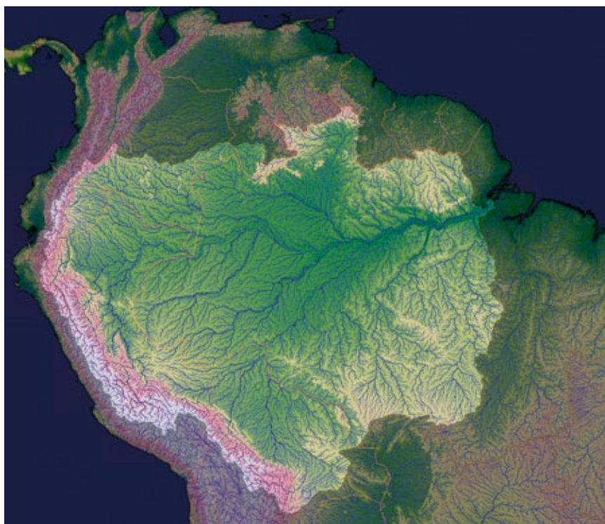
Auch das gewaltige Netzwerk des Amazonas (blau; die anderen Farben im hellen Bereich geben unterschiedliche Höhen an) entsteht, weil jedes Fleckchen Erde so entwässert werden muss, dass die Energiedissipation des Gesamtsystems möglichst klein wird.
