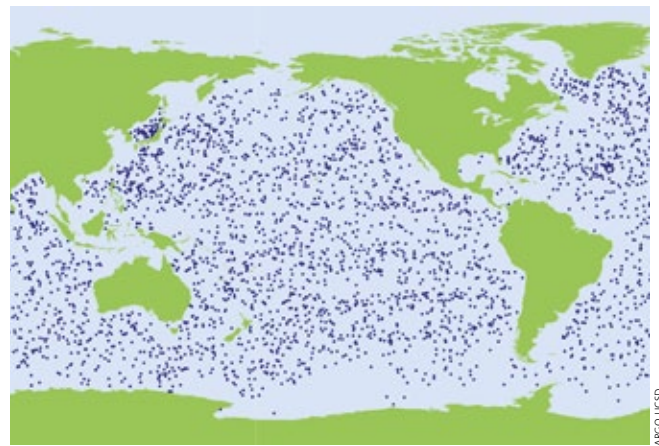
Mehr als 3000 Schwimmkörper erfassen im Projekt Argo fortlaufend die Temperaturen und Salzgehalte in den Ozeanen. Die Weltkarte (Ausschnitt) zeigt ihre Positionen im März 2013.
