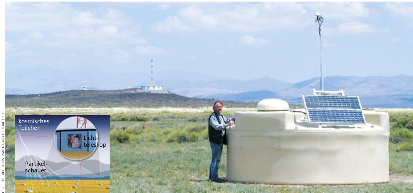
Mitten in der Pampa Westargentiniens stehen die Wassertanks des Pierre Auger Telescope. Schlagen Luftschauerteilchen in diese Detektoren ein, können Forscher Richtung und Energie der kosmischen Primärpartikel rekonstruieren. Im Hintergrund sichtbar ist eines der Teleskope, die simultan UV-Licht angeregter Luftmoleküle registrieren (siehe auch kleines Bild links).
