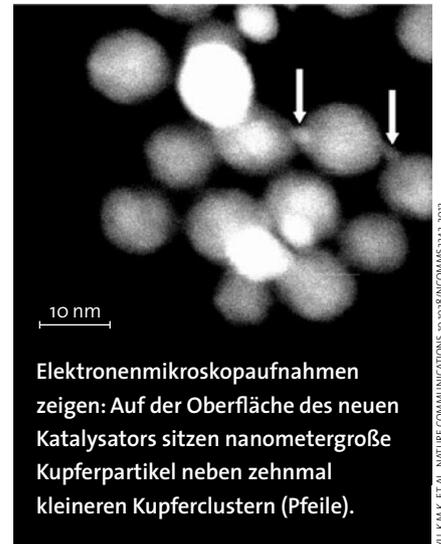
Elektronenmikroskopaufnahmen zeigen: Auf der Oberfläche des neuen Katalysators sitzen nanometergroße Kupferpartikel neben zehnmal kleineren Kupferclustern (Pfeile).
