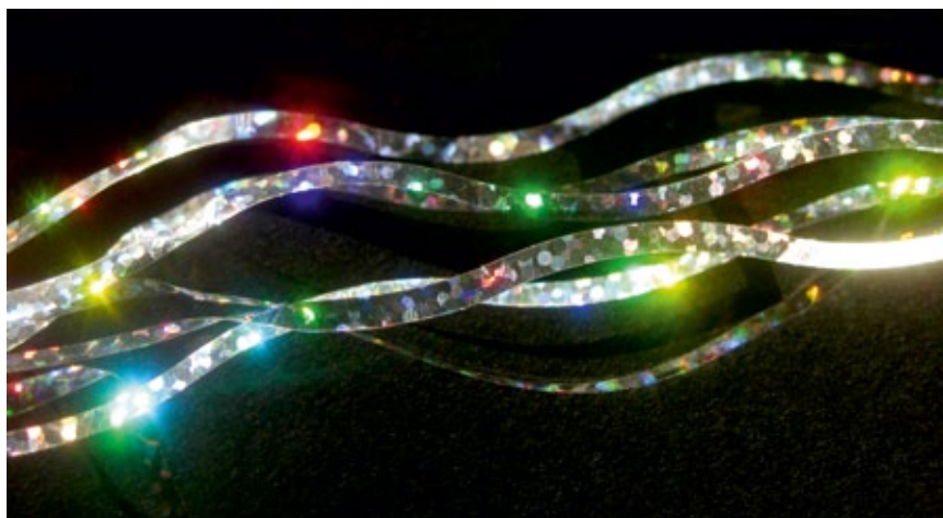
Das Glitzern von Kunststofflametta wird von kreisförmigen Plättchen hervorgebracht, deren winzige Strukturen als optische Gitter fungieren.
