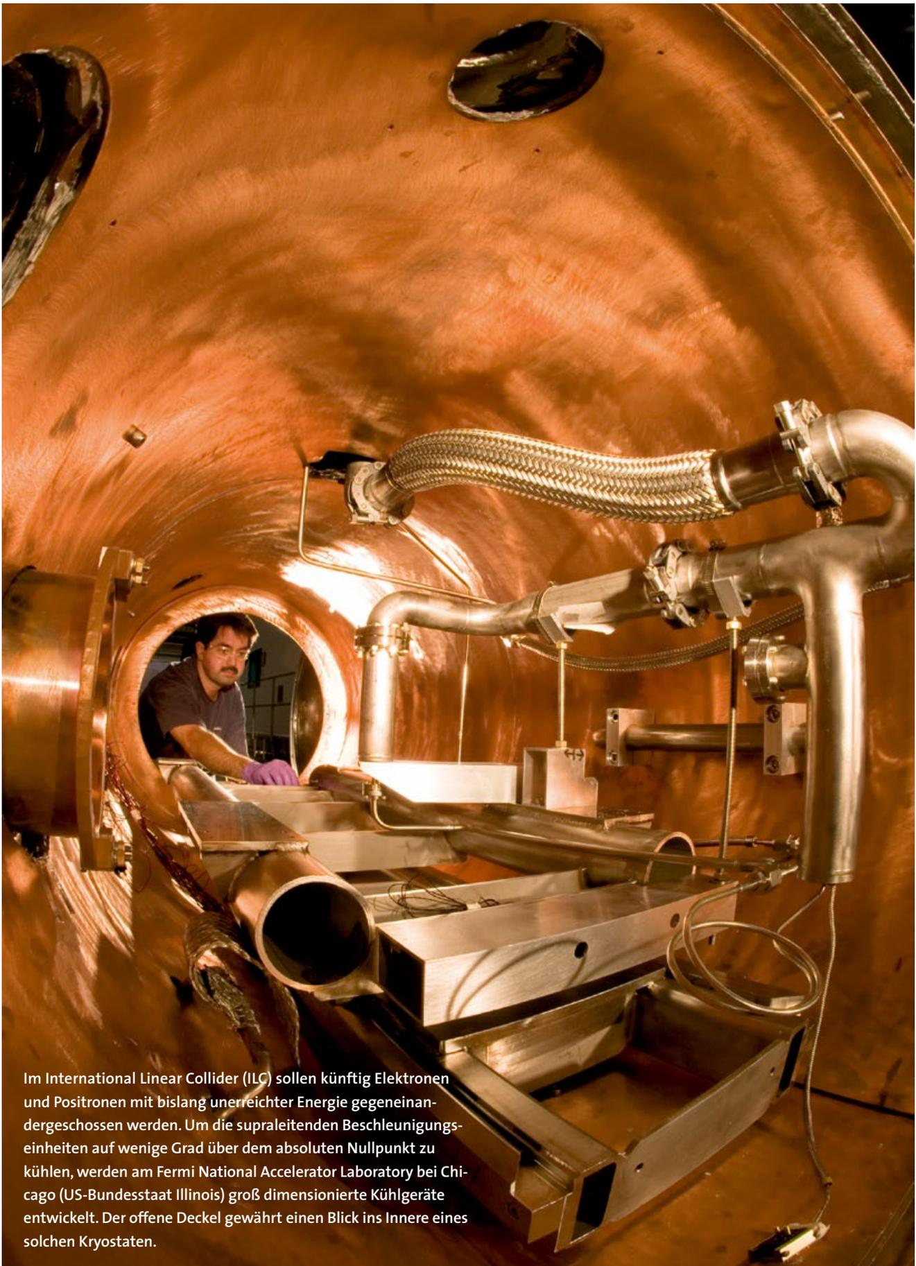
Im International Linear Collider (ILC) sollen künftig Elektronen und Positronen mit bislang unerreichter Energie gegeneinandergeschossen werden. Um die supraleitenden Beschleunigungseinheiten auf wenige Grad über dem absoluten Nullpunkt zu kühlen, werden am Fermi National Accelerator Laboratory bei Chicago (US-Bundesstaat Illinois) groß dimensionierte Kühlgeräte entwickelt. Der offene Deckel gewährt einen Blick ins Innere eines solchen Kryostaten.
