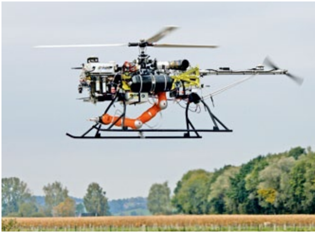
Mit seinem Roboterarm kann ein unbemannter Kleinhubschrauber in unwegsamem Gelände einem in Not Geratenen Hilfe bringen, Gegenstände wegschaffen oder sogar Hochspannungsleitungen reparieren.
