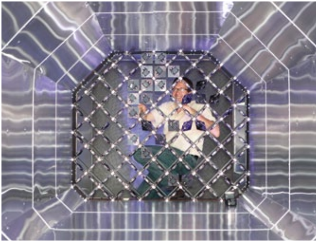
Eberhard Bodenschatz prüft ein neues Gitter für den Windkanal (oben). Es hat flexibel einstellbare Öffnungen, mit denen sich unterschiedliche Wirbelmuster erzeugen lassen. Das Gitter wird nachher in den roten Turbulenzwindkanal (rechts) eingebaut, der sich in dem Gebäude über zwei Stockwerke zieht.
