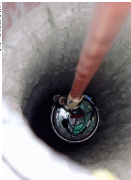
Für IceCube wurden über 5000 lichtempfindliche Sensoren kilometertief ins antarktische Eis eingelassen.
