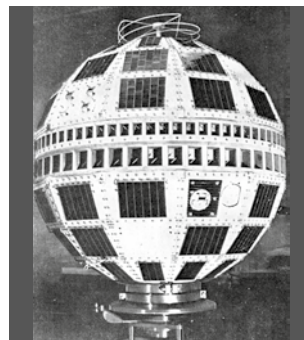
Der erste Fernsehsatellit »Telstar« vermittelte 60 Telefonverbindungen, Fernsehen und Bildfunk gleichzeitig.
