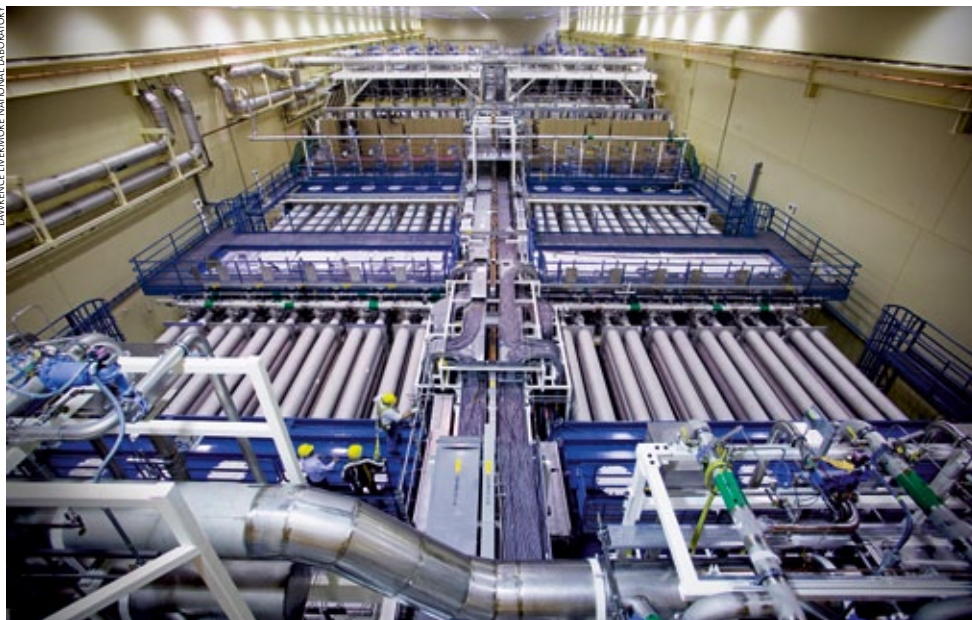
Eine von zwei Laserhallen der National Ignition Facility am Lawrence Livermore National Laboratory in Kalifornien: Jede der beiden Hälften links und rechts des Wartungsflurs in der Mitte enthält exakt 48 Strahlrohre. Bei einem Schuss verteilt sich ein Saatpuls auf 192 nahezu identische Pulse, die simultan verstärkt werden und dann gleichzeitig zum Target gelangen.
