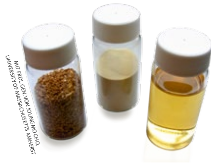
Die Pyrolyse verwandelt Holzstückchen (links) durch sekundenlanges Erhitzen auf über 400 Grad Celsius bei Zugabe eines Katalysators (Mitte) in »Bioöl« (rechts).
