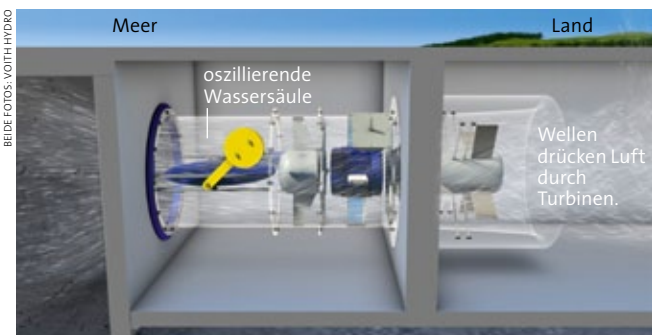
Auf der britischen Insel Islay treiben Wellen die Turbinen der Testanlage »Limpet« (Napfschnecke) an.
