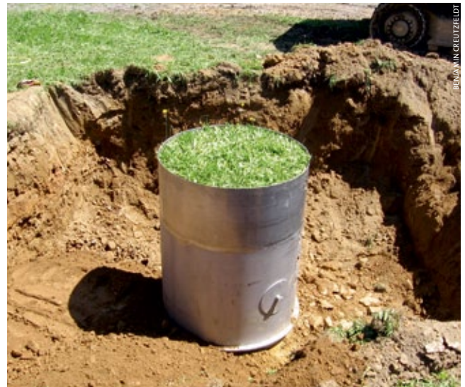
Die Forscher stanzen einen tonnenschweren Block aus dem Erdreich, um darin die Bewegungen des Sickerwassers zu studieren.
