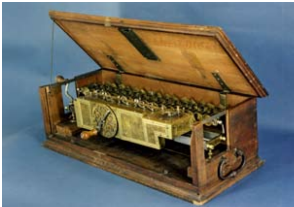
1671 präsentierte Leibniz in Paris seine erste Rechenmaschine – hier ein Nachbau des zweiten Modells.
