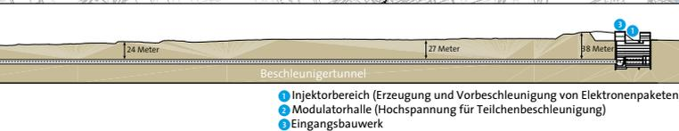
Die 3,4 Kilometer lange Anlage des Röntgenlasers erstreckt sich vom DESY-Gelände bis in die schleswig-holsteinische Stadt Schenefeld. Die untere Grafik deutet den Verlauf des Höhenprofils an.
