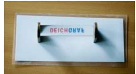
»Dieser Zylinder besteht aus einem Material mit stark wellenlängenabhängigem Brechungsindex. Deswegen wirkt er auf rotes Licht wie eine gewöhnliche Lupe, während er die blaue Schrift auf den Kopf stellt.« Alles Unfug – der Glasstab stellt wie jede Zylinderlinse einfach alles auf den Kopf; aber das kommt einem bei dem Wort »DEICH« nicht als Erstes in den Sinn.
