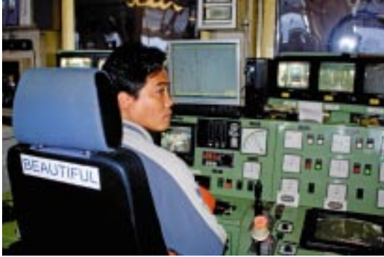
Perez Alvin ist Herr über die mächtigen Winden (rechts). Mit ihrer Hilfe zieht er die »Castoro Sei« an armdicken Seilen zu den in großer Entfernung vom Schiff versenkten Warp-Ankern.
