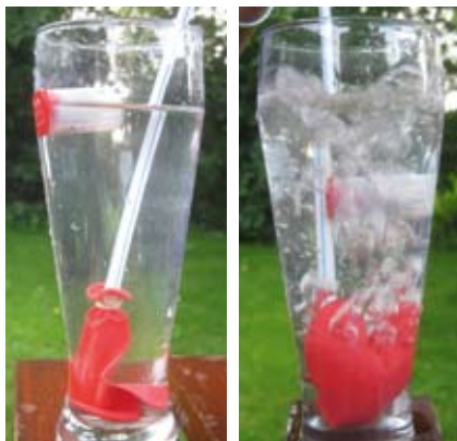
Ein »Schiff«, hier eine halb mit Wasser gefüllte Filmdose, sinkt im Sprudelbad aus aufsteigenden Gasblasen. Diese stammen aus einem durchlöchernten Luftballon am Glasboden, in den der Experimentator durch einen Strohhalm Luft bläst.
