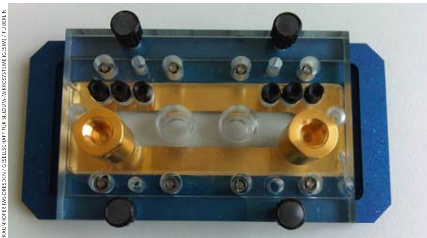
Flüssigkeitsgefüllte Kanäle simulieren den Blutstrom zu den »Organen« auf dem Chip (hier der Doppelkammerkreislauf einer Dresdner Forschungs Kooperation).
