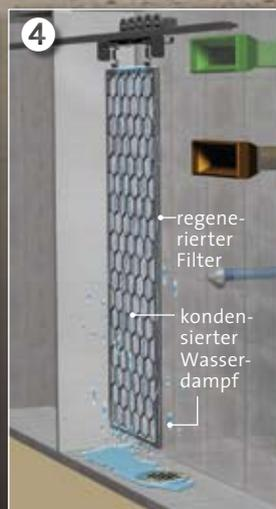
Die Regeneration eines Filters beginnt mit dem Evakuieren der Kammer (1). Dann wird der Filter mit Wasserdampf besprüht; dabei wird Bikarbonat wieder zu Karbonat.  $\text{CO}_2$  kommt frei (2) und kann abgepumpt und komprimiert werden (3). Restliches Wasser läuft zur erneuten Verwendung ab (4).
