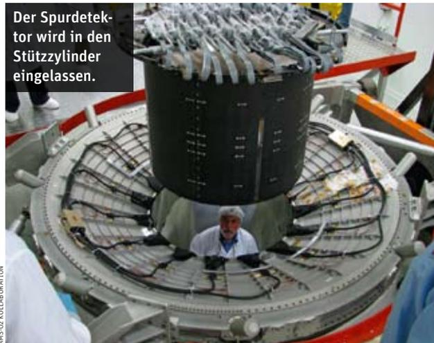
Der Spurdetektor wird in den Stützzylinder eingelassen.
