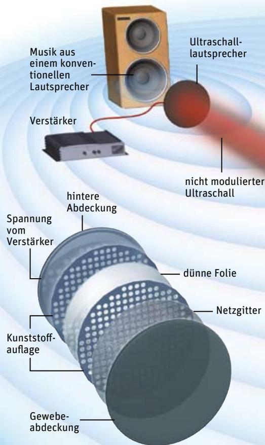
Ein nur einen Zentimeter dicker Lautsprecher wird von einem Verstärker gespeist, der eine Spannung an eine leitfähige Kunststoffolie schickt. Die Folie schwingt mit 60 000 Hertz oder mehr und erzeugt dabei Ultraschallwellen.
