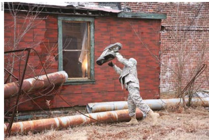
Ein Soldat wirft einen PackBot durch ein Fenster. Die Videokameras des Überwachungsroboters liefern dann eine Innenansicht der Räumlichkeiten.
