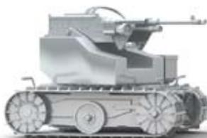
**MAARS:** Mit Maschinengewehr und Granatwerfer ist dieser 160 Kilogramm schwere Wachposten und Scharfschütze ausgestattet.
