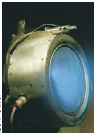
Geladene Xenonatome verursachen das blaue Glühen in diesem Ionenantrieb. Das Bild zeigt ein in einer Vakuumkammer testweise gezündetes Aggregat mit einem Durchmesser von rund 40 Zentimetern.
