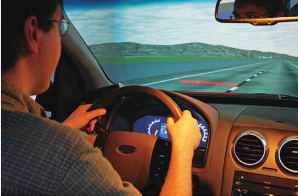
Ein in die Windschutzscheibe eingespiegelter roter Lichtstreifen weist im VIRTTEX-Simulator auf potenzielle Hindernisse hin (links). Rundumblicke auf die Verkehrssituation erlauben Weitwinkelkameras, die ihre Aufnahmen auf Navigationsbildschirme übertragen (rechts).
