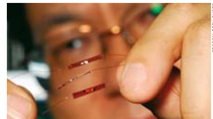
Zhong Lin Wang präsentiert den Prototyp seiner flexiblen »Ladungspumpe«. Der Generator erzeugt Wechselstrom, wenn die Zinkoxiddrähte periodisch gedehnt und gestaucht werden.
