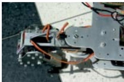
Körpergefühl mit Fotozelle: Durch Selbstbeobachtung findet der sechsbeinige Laufroboter von Matthias Schnaubelt den richtigen Kraftaufwand für eine geplante Bewegung.
